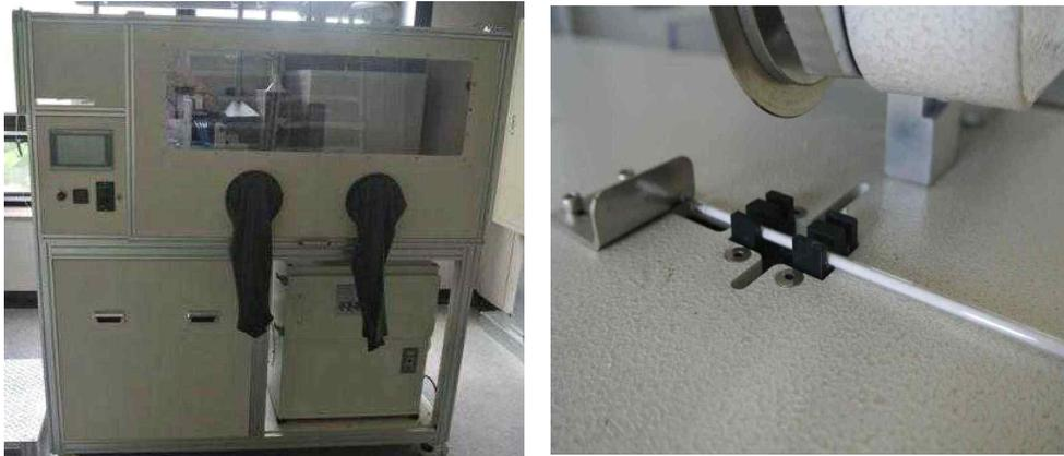
그림 1. CCFL 무해화 처리 시스템(부스) 및 절단 설비
