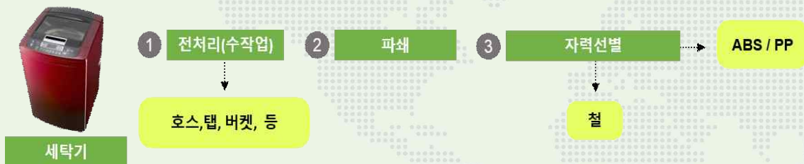
<그림 10> 세탁기 재활용 공정 (파쇄기 & 자력선별기 사용)
