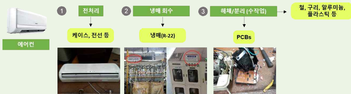
<그림 11> 에어컨 재활용 공정 (냉매 회수 및 수작업 공정)
